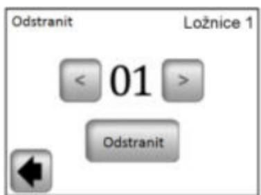
Pomocí tlačítek (<) nebo (>) vyberte zónu určenou ke smazání a stiskněte tlačítko „**Odstranit**“. Aby nedošlo k nechtněmu smazání zóny, je vyžadováno potvrzení ke smazání stisknutím tlačítka „**Ano**“.
