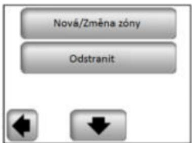
Tlačítko „**Nová/Změna zóny**“ umožňuje přidat novou zónu, nebo upravit/změnit některou stávající zónu. Způsob párování je popsán v kapitole 2.3.
