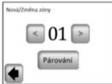
Nyní přepněte hlavní přijímač (obvykle přijímač V23) dané místnosti/zóny do režimu „RF init“ stisknutím párovacího tlačítka po dobu 3 vteřin – LED dioda na párované jednotce se rozsvítí zeleně
