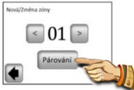
Řídící jednotka hledá přijímač v režimu „RF ini“
