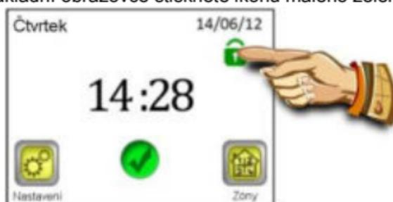
Na následující obrazovce uzamkněte displej podržením tlačítka „Uzamknout“ po dobu 5 vteřin
