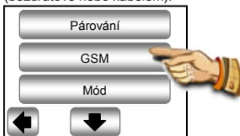
Pokud bude mezi řídící jednotkou V24 a modulem V27 použita bezdrátová komunikace, je nutné nejdříve provést propojení (párování) obou jednotek.
