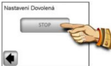
**Poznámka:** V režimu „Doma“ je zobrazena základní obrazovka, umožňující přístup ke všem funkcím, doplněná o symbol „Dovolená“ s datem návratu. Předčasné ukončení funkce provedete stisknutím symbolu a stiskem následně zobrazeného tlačítka „STOP“.
