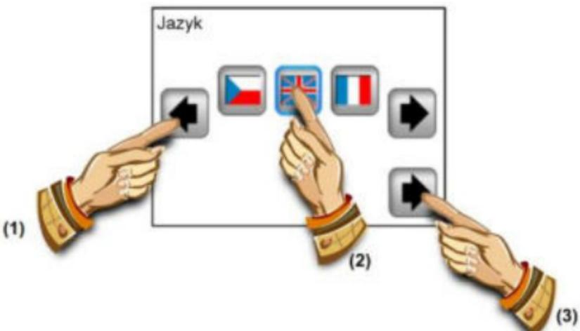
Zvolte formát požadované stupnice přímým stisknutím odpovídajícího tlačítka (zvolená hodnota je orámována modře).
