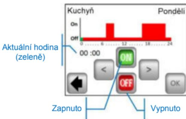
Ovládání na přijímači V25 umožňuje jeho přímé nastavení (On/Off, timer 2Hod) a je nadřazeno pokynům centrální jednotky.
