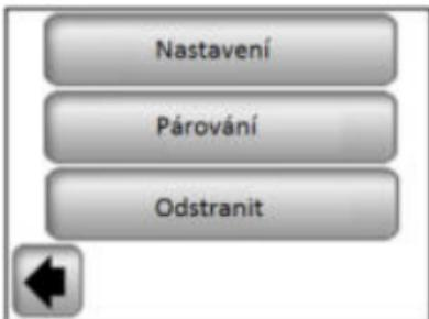
1. Přídavnou RF anténu Vašeho GSM modulu přepněte do režimu párování (RF init) stisknutím tlačítka RF po dobu 3 vteřin. LED dioda na anténě začne svítit zeleně. Nyní stiskněte tlačítko „**Párování**“ na Vaší centrální jednotce a proběhne párování obou jednotek.
